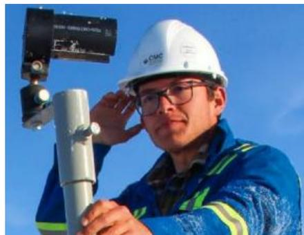
A medida que la tecnología de detección de metano escaneaba un área de 7.5 km<sup>2</sup>, se monitoreó y evaluó el rendimiento del equipo. Las pruebas ayudaron a ajustar y adaptar el equipo periférico del sistema a las características específicas del entorno canadiense para asegurar el máximo rendimiento y un monitoreo casi continuo.
